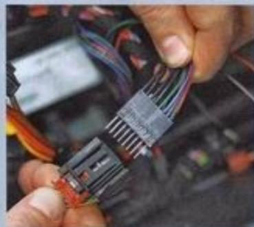
**KABEL VERBINDEN** Den Stecker am Verdecksteuergerät abziehen und das neue Gerät dazwischenstecken
