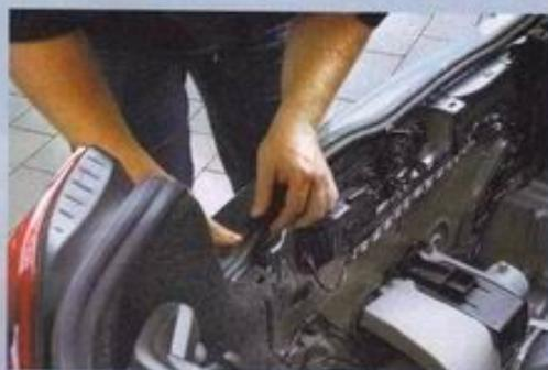
**KOFFERRAUM RÄUMEN** Die Abdeckung des Reserverads, der Gepäckraumtrenner sowie die Plastikverschalung am Heck müssen samt Dichtung raus
