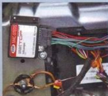
**STEUERGERÄT FIXIEREN** Hinter dem Seitenteil ist genug Platz, um das Gerät mit Klettbindern zu befestigen
