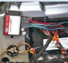
**STEUERGERÄT FIXIEREN** Hinter dem Seitenteil ist genügend Platz, um das Gerät mit Klebtändern zu befestigen
