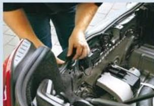
**KOFFERRAUM RÄUMEN** Die Abdeckung des Reserverads, der Gepäckraumtrenner sowie die Plastikverschalung am Heck müssen samt Dichtung raus
