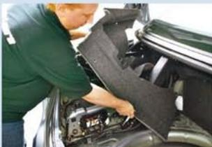
**SEITENTEIL ENTFERNEN** Das Verdeck-Steuergerät versteckt sich hinter dem linken Seitenteil, für eine bessere Zugänglichkeit wird die Abdeckung angehoben
