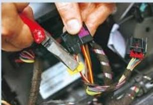
**STROM ANSCHLIESSEN** Ein Steckverbinder wird an die rot-gelbe Zwölf-Volt-Leitung des VW Eos geklemmt, ein anderer an das braune Massekabel des Wagens
