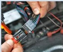
**KABEL VERBINDEN** Den Originalstecker am Verdecksteuergerät des Autos abziehen und das Zusatzsteuergerät dazwischenstecken
