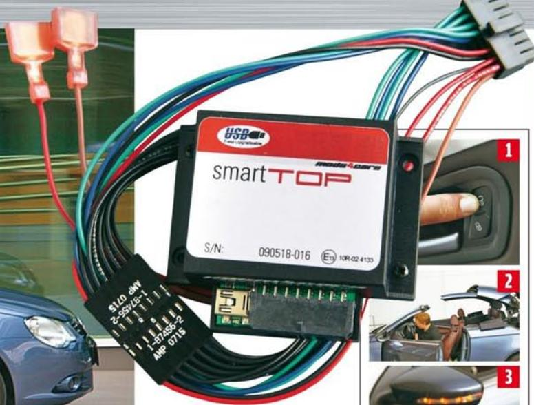
Nachrüst-Steuergerät: Über einen Adapterstecker lässt sich Smarttop in den Kabelbaum des Autos klemmen. Selbst ungeübte Bastler brauchen für den Einbau nicht länger als eine Stunde, in der Werkstatt kostet die Montage rund 70 Euro
